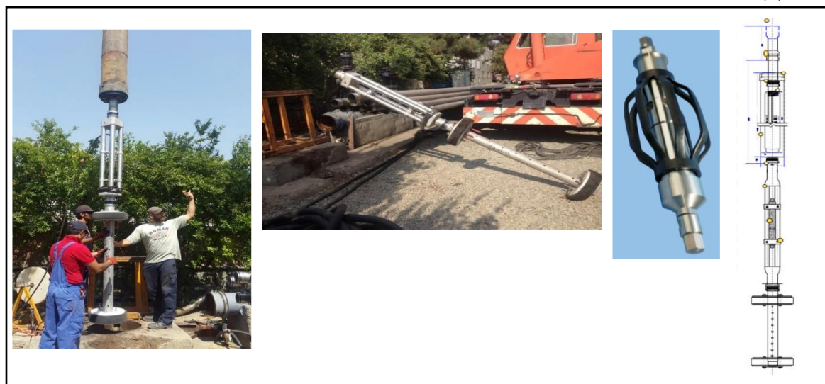
شکل ۱۰- از سمت راست: ۱) مجموعه تجهیز پمپاژ موضعی و تفنگ گازی، ۲) تفنگ گازی یا ژنراتور پالس، ۳) محفظه تفنگ گازی و محفظه مکش، ۴) مجموعه تجهیزات در حین ورود به چاه
