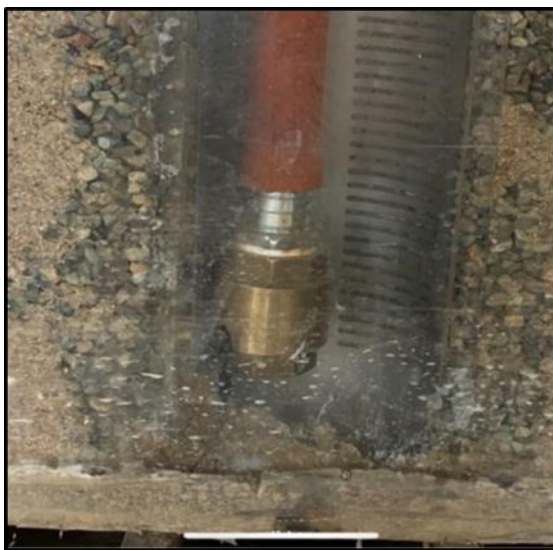
شکل ۳- میزان فرسایش اطراف لوله جدار
