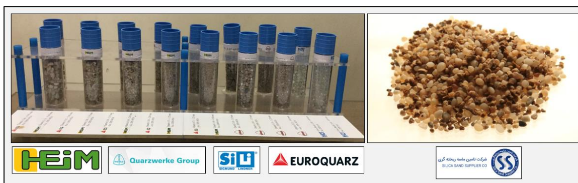
شکل ۳- نمونه گراول با کیفیت استاندارد DIN ۴۹۲۴
